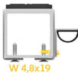
schemat montażu ogranicznika przy drzwiach otwieranych do wewnątrz pomieszczenia
