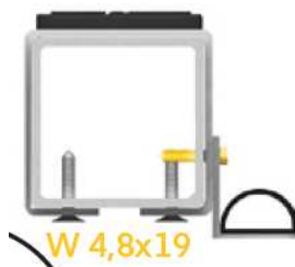
schemat montażu ogranicznika przy drzwiach otwieranych na zewnątrz pomieszczenia
